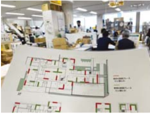
緑の線が現在耐震化して筋交を入れた部分。大地震がきても業務を継続するには赤の線へも追加の筋交が必要
